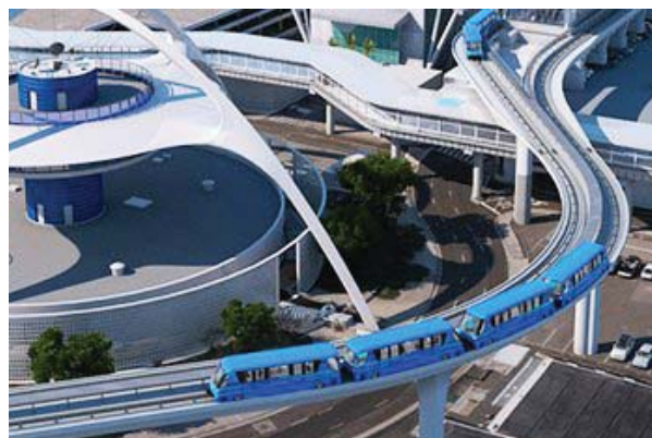
Système de navettes automatisé INNOVIA APM développé pour l'aéroport international de Los Angeles (LAX)
