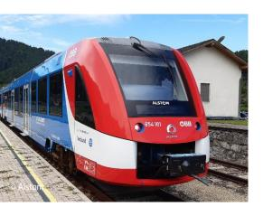
**11. September 2020** – In Wien startet heute eine neue Ära: Bis Ende November wird erstmals ein Wasserstoffzug im regulären Fahrgastbetrieb der Österreichischen Bundesbahnen (ÖBB) eingesetzt. Der von Alstom im niedersächsischen Salzgitter gebaute Coradia iLint hat Brennstoffzellen an Bord, die Wasserstoff und Sauerstoff in Strom umwandeln und so den Schadstoffausstoß auf Null reduzieren.
