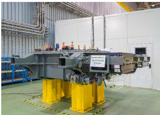
Тартым трансформаторлары 2-ден 10 МВА-ға дейінгі толық қуат диапазонымен
